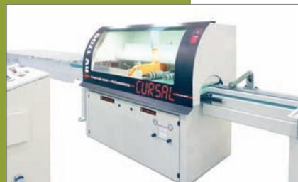
Per il taglio di lamelle costituenti le travi lamellari, Cursal propone l'ottimizzatrice rapida serie “**TRV 1700**”. La linea ideale è composta da un caricatore automatico a ventosa Cursal, da un misuratore
