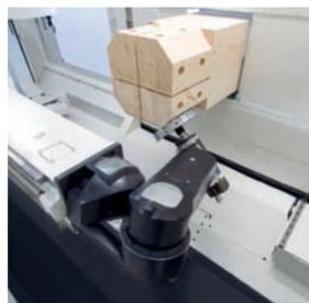
centro di lavoro cnc di SCM per l’edilizia in legno. Uno dei principali vantaggi di “Oikos XL” è la gestione e la **lavorazione automatica** di elementi di peso notevole, grazie a una struttura meccanica molto robusta e ad affidabili sistemi di bloccaggio.
